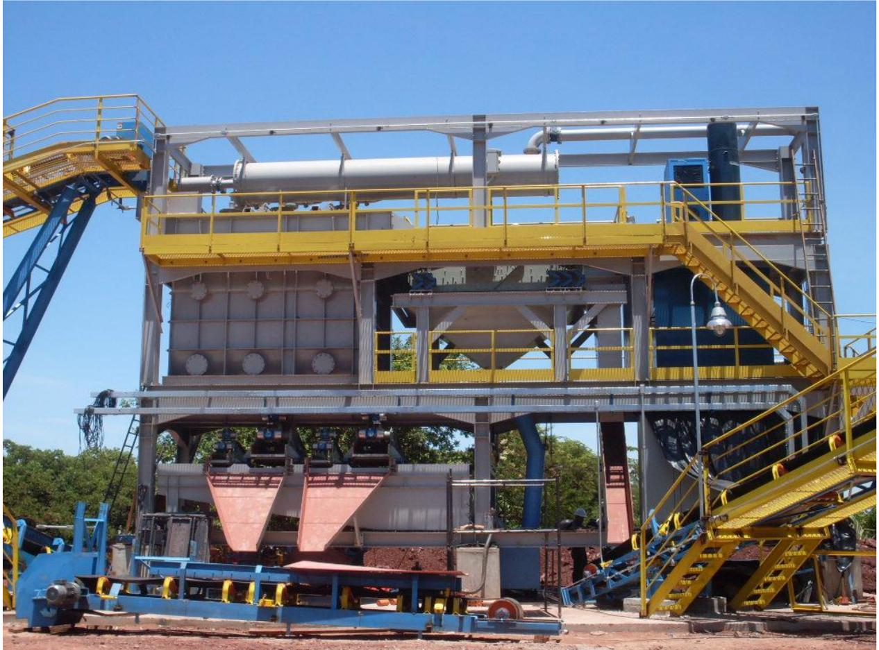
O Jigue pneumático ORETEC é um equipamento de separação gravimétrica que separa o material em fração pesada (na parte inferior do leito) e fração leve (na parte superior do leito).
