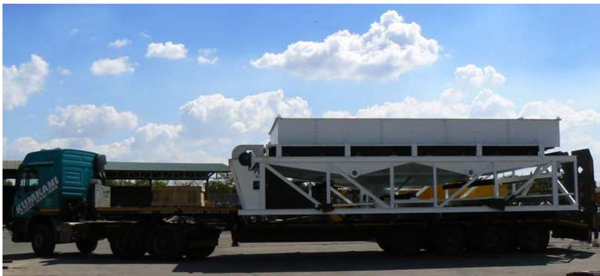
Peneira linear sendo transportada para o cliente totalmente montada.
