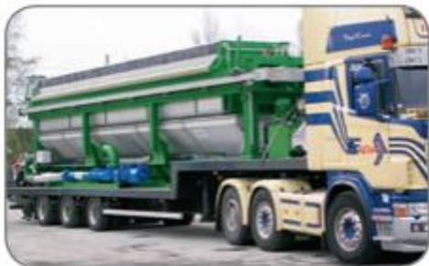
Dependendo da quantidade de material seco a ser tratado, nós projetamos unidades móveis em semi-reboques ou chassis convencionais, bem como filtros prensa instalados em contêineres marítimos ou diretamente em uma estrutura de aço.
