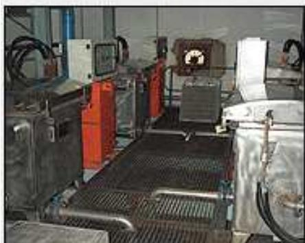
A célula eletrolítica consiste em um arranjo em “sanduíche” de sete conjuntos de anodo de cada lado do compartimento de cátodo, todos contidos num tanque de aço inoxidável. Os catodos são constituídos de tanques em aço inoxidável com catodos em lã de aço inox. Os anodos são construídos a partir de tiras de aço inoxidável. Catodos e anodos são posicionados alternadamente dentro da célula.
