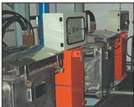
A recuperação de ouro do eluido CIP é eficientemente realizada através da utilização da célula eletrolítica do tipo leito compacto. Os eluidos contendo ouro e prata gerados a partir de eluição tipo Zadra ou tipo AARL são adequados para eletrodeposição em células de leito compacto Kemix, de construção robusta e fácil operação.
