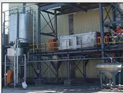
O desenho do tubo de rértorta e velocidade periférica adequada garantem a exposição completa do leito de carvão e sua completa regeneração térmica ou reativação.
