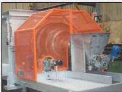
O tubo retorta é fabricado em ligas especiais para suportar as altas temperaturas associadas com a regeneração térmica ou reativação. O processo de soldagem e modo de construção, com tolerâncias rigorosas tanto em retidão como em concentricidade, bem como a ausência de barras levantadoras garante maior vida útil ao forno e também reduz o atrito do carvão com a tradicional queda do leito.
