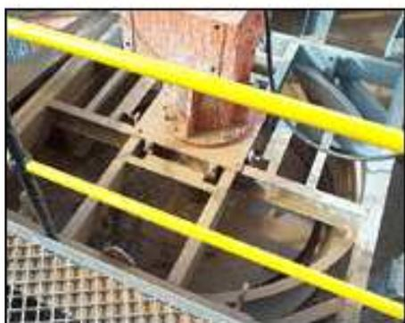
As lâminas da turbina, acoplada ao eixo de acionamento, gira em torno do selo hidráulico e suspende a polpa contida na peneira. No caso de uma paralisação da planta, a polpa contida dentro da tela pode decantar e é re-suspensa quando reinicia o acionamento.
