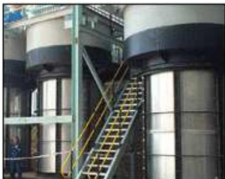
A peneira MPS incorpora uma cesta cilíndrica em wedgewire (arame com perfil triangular) ou tela fixada na parte inferior da voluta. A tela wedgewire é cilíndrica para facilitar a distribuição uniforme do fluxo de polpa através da tela. Isso resulta em um padrão de desgaste uniforme, aumentando assim a vida útil da cesta.
