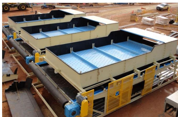
Peneira linear sendo transportada para o cliente totalmente montada.
