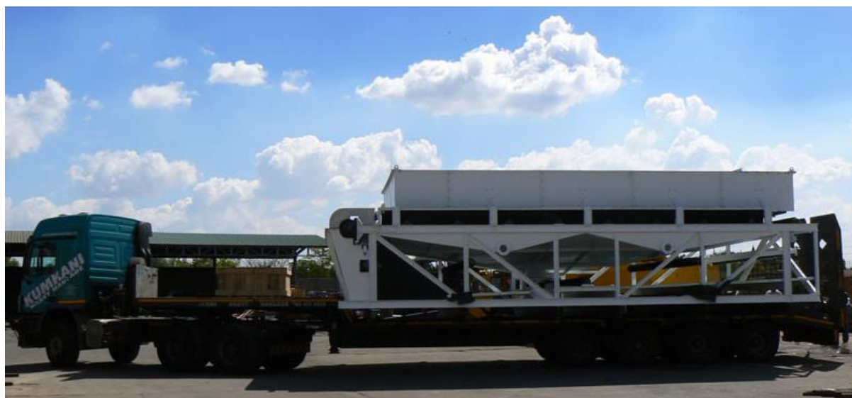
Peneira linear sendo transportada para o cliente totalmente montada.
